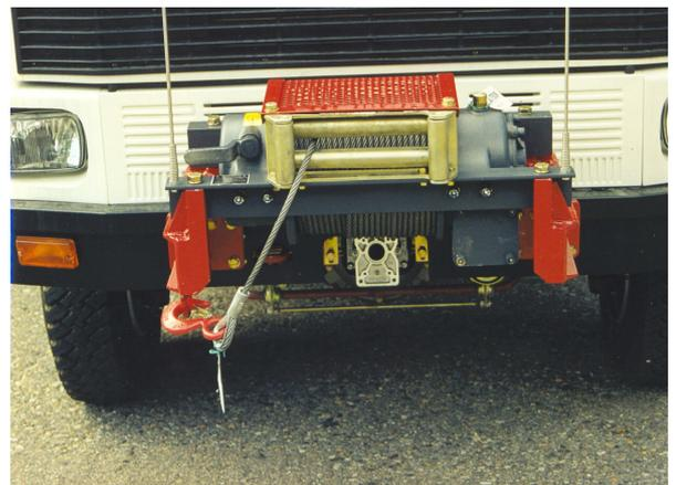
Les séries **4000, 4700 et 5700** peuvent être facilement installées sur des tracteurs, des remorques, des pelles mécaniques mobiles, des bennes, des mini-excavateurs et des machines agricoles de 50/60 CV.
