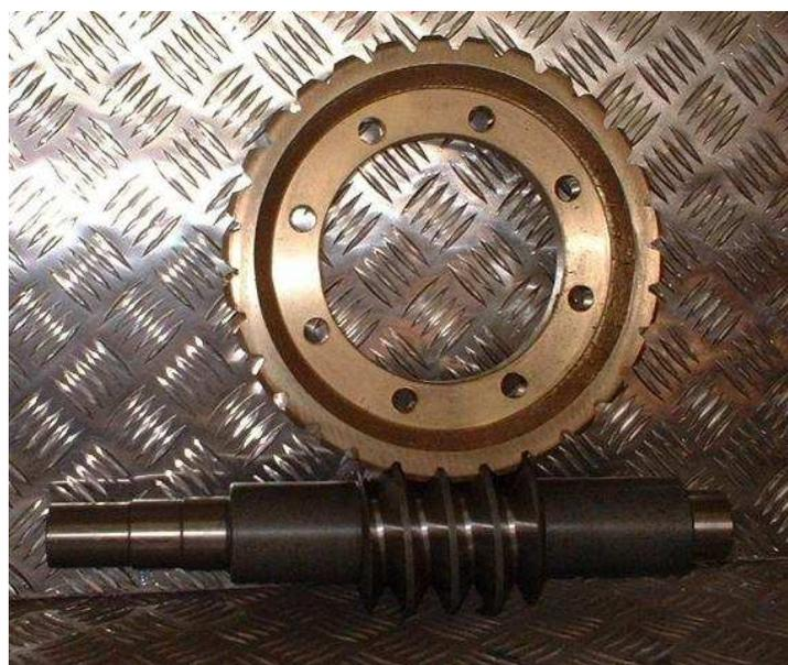
Ello permite operar con el máximo nivel de seguridad. De hecho, si lo comparamos con otros tipos de reducciones, como por ejemplo engranajes ordinarios o epicicloidales, nuestros acoplamientos de corona helicoidal de bronce y rosca sin fin tienen la ventaja de impedir que se verifique un movimiento reversible accidental.
