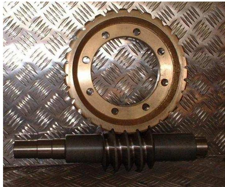
Dieses System gewährleistet die höchste Sicherheit während des Betriebs. Im Vergleich zu anderen Untersetzungsgetrieben (z.B. üblichen oder Planetengetrieben) haben diese Getriebe mit Bronze-Schneckenrad und Schnecke den Vorteil, dass sie eine zufällige umkehrbare Bewegung verhindern.
