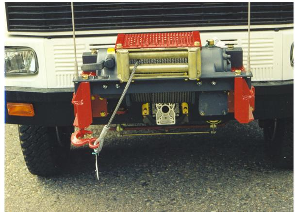
Die Serien **4000, 4700** und **5700** werden einfach auf Traktoren, Anhängern, Radladern, Baggerladern, Minibaggern und Landmaschinen mit einer Kraft höher als 50/60 PS montiert.
