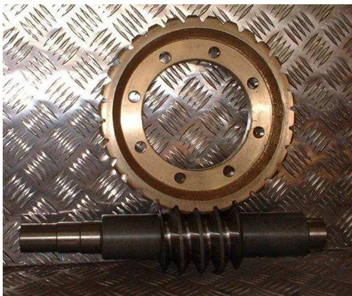
Isto consente agir com o máximo grau de segurança. De fato, se comparados com outros tipos de redução, como por exemplo engrenagens comuns ou epicicloidalis, as nossas junções com coroa helicoidal em bronze e parafusos sem fim tem a vantagem de impedir um movimento reversível acidental.
