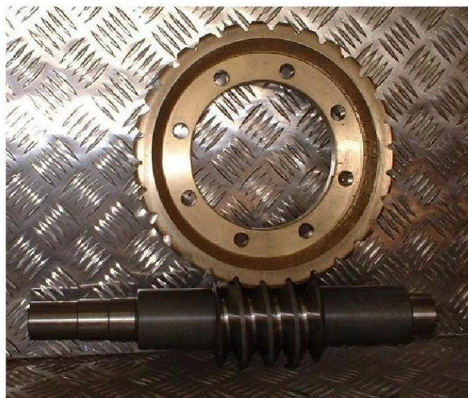
Ciò consente di operare con il massimo grado di sicurezza. Infatti, se confrontati con altri tipi di riduzioni, come ad esempio ingranaggi ordinari o epicicloidali, i nostri accoppiamenti a corona elicoidale in bronzo e vite senza fine hanno il vantaggio di impedire il verificarsi di un moto reversibile accidentale.
